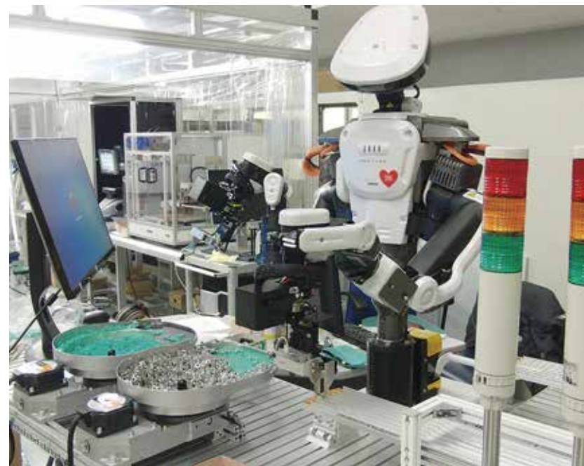
作業指示書をもとに、ナット及びナットホルダーの整列作業を行う双腕ロボット
