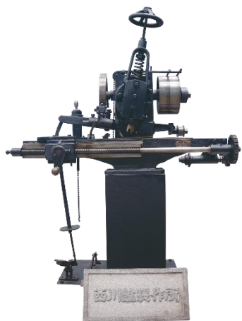
創業当時の「ヤスリ目立て機」 1927年4月西川鑪製作所を設立 鑪(やすり)製造および加工を行う
