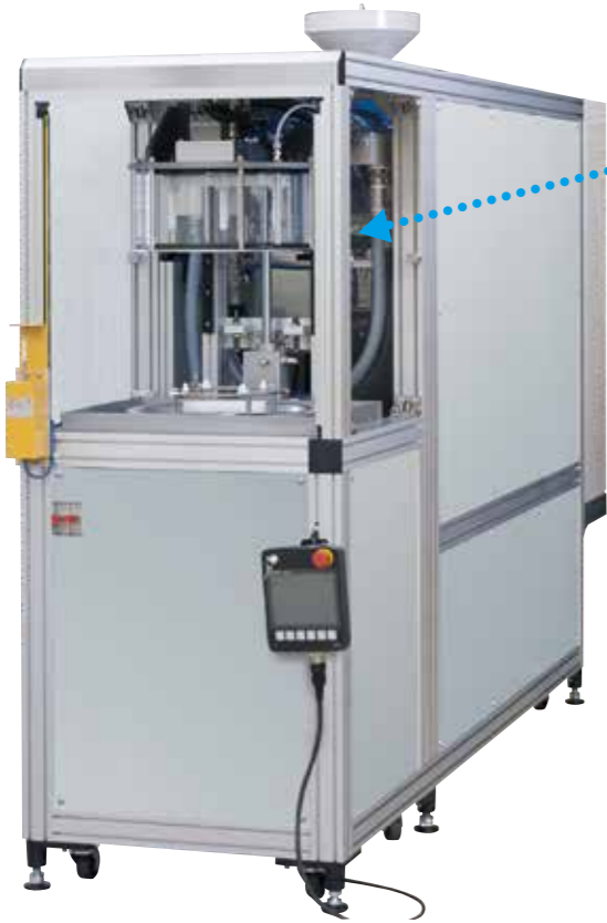
仕上げ洗浄機 NCL215 ロータイプ 専用ノズル 製造ラインを見渡せるコンパクトボディ
