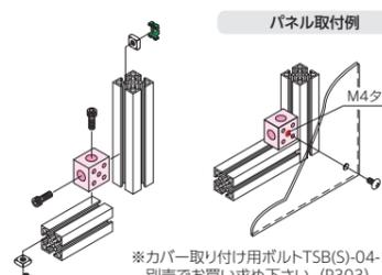
\*1 片面にM4タップが施してあります。 \*2 締結ボルトと四角ナットがステンレス製となります。 \*3 締結ボルトの推奨締付トルク及び比較。(P470-P471)
