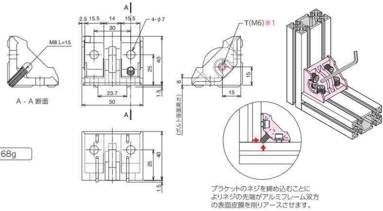
ブラケットのネジを締め込むことによりネジの先端がアルミフレーム双方の表面皮膜を削りアースさせます。
