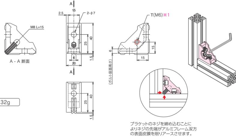
ブラケットのネジを締め込むことによりネジの先端がアルミフレーム双方の表面皮膜を削りアースさせます。
