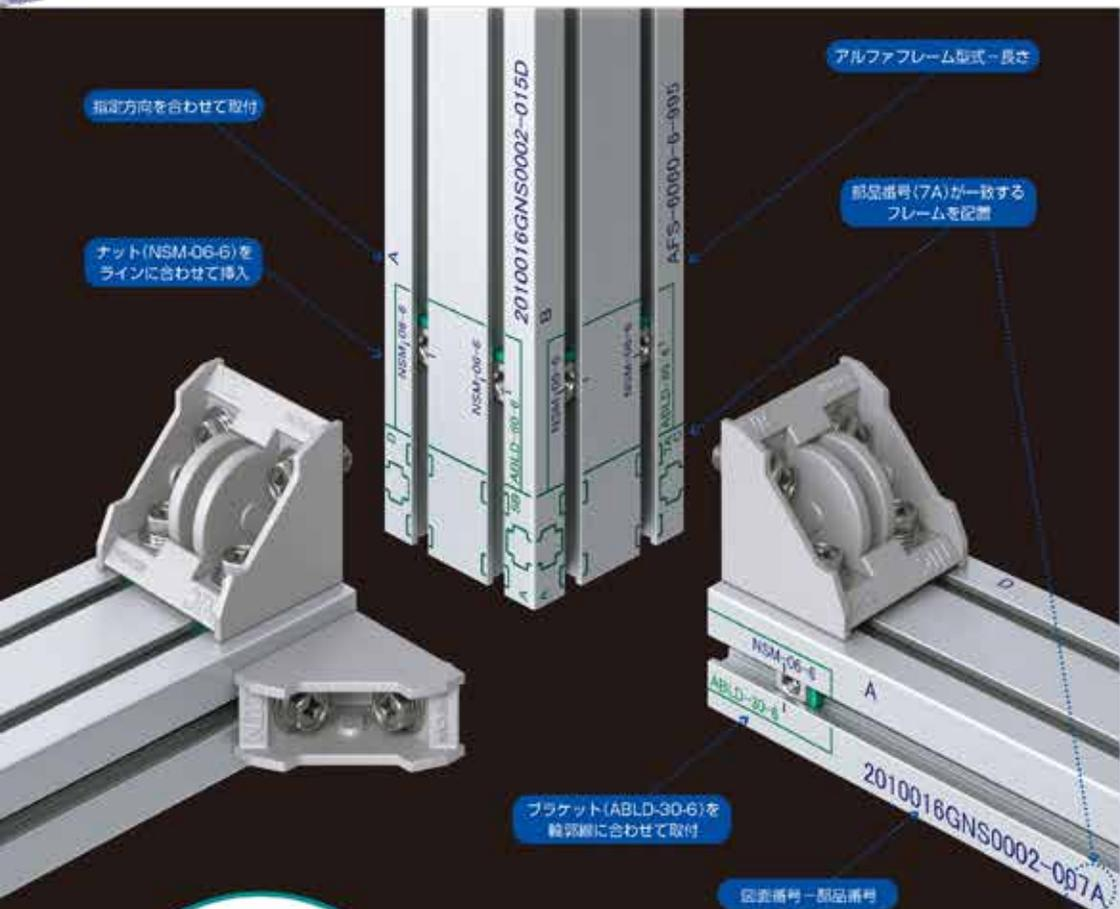
組立時間の4割を占める「部材を探す、組立手順を考える、寸法を測る…」という作業を「アルミフレームに直接設計図を印刷する」ことで大幅カット。見えないコストを短縮し、組立やすさを実現しました。特殊プリンタを用いた「マーキングシステム™」は世界初、NIC独自の技術です。
