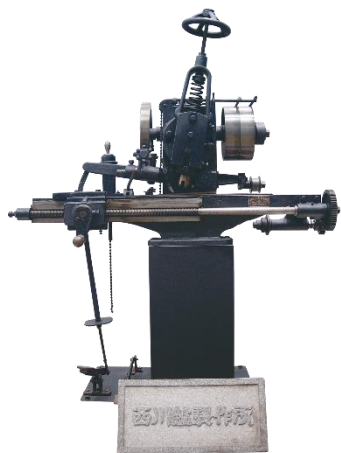
創業当時の「ヤスリ目立て機」 1927年4月西川鑄製作所を設立 鑄(やすり)製造および加工を行う
